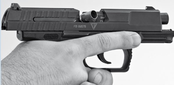
Łuska zakleszczona w oknie wyrzutnika.
