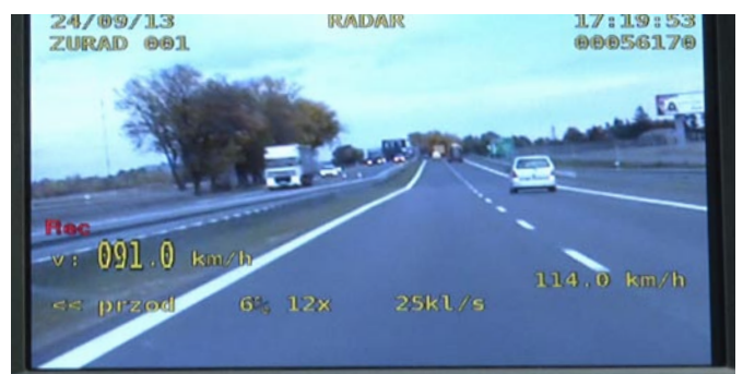
Obraz z monitora Videorapid 2A. Przekroczenie prędkości przez pojazd jadący prawym pasem ruchu
