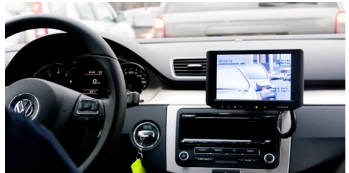
Na monitorze jest wyświetlany obraz przekazywany do urządzenia Videorapid 2A z tylnej kamery
