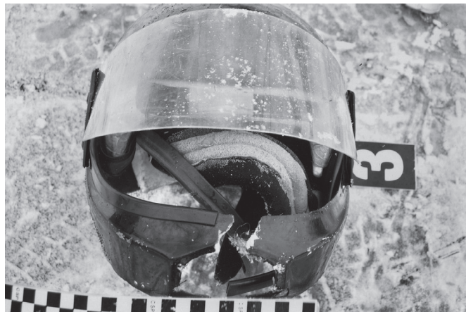
Uszkodzony kask ochronny
