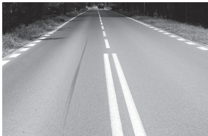
Ślad blokowania tylnego koła motocykla
