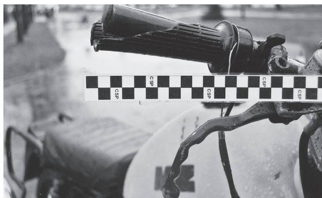
Uszkodzona manetka przepustnicy
