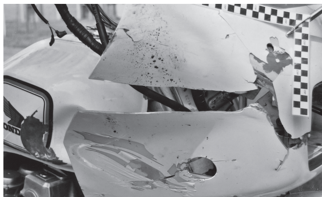
Rozerwana część owiewki motocykowej
