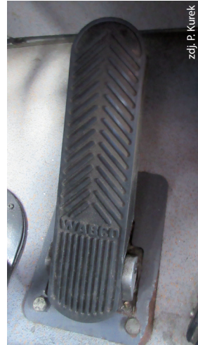
Fot. 5. Kontrola nakładki antypoślizgowej.
