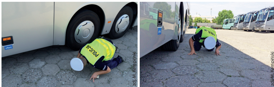
Fot. 14. Kontrola zawieszenia.
