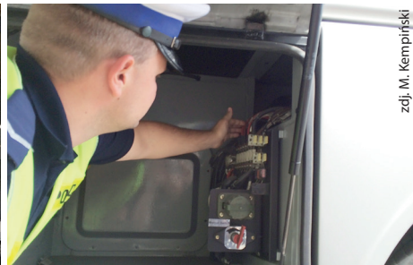
Fot. 12. Kontrola mocowania akumulatorów i instalacji elektrycznej.
