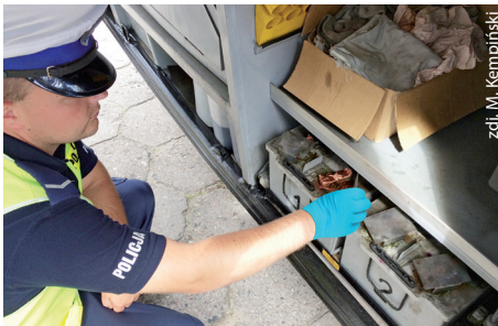
Fot. 12. Kontrola mocowania akumulatorów i instalacji elektrycznej.
