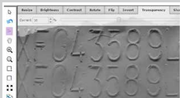
Fot. 15. Porównanie dwóch replik silikonowych przy użyciu funkcji powiększeń – odwrócenia obrazów oraz transparentności.
