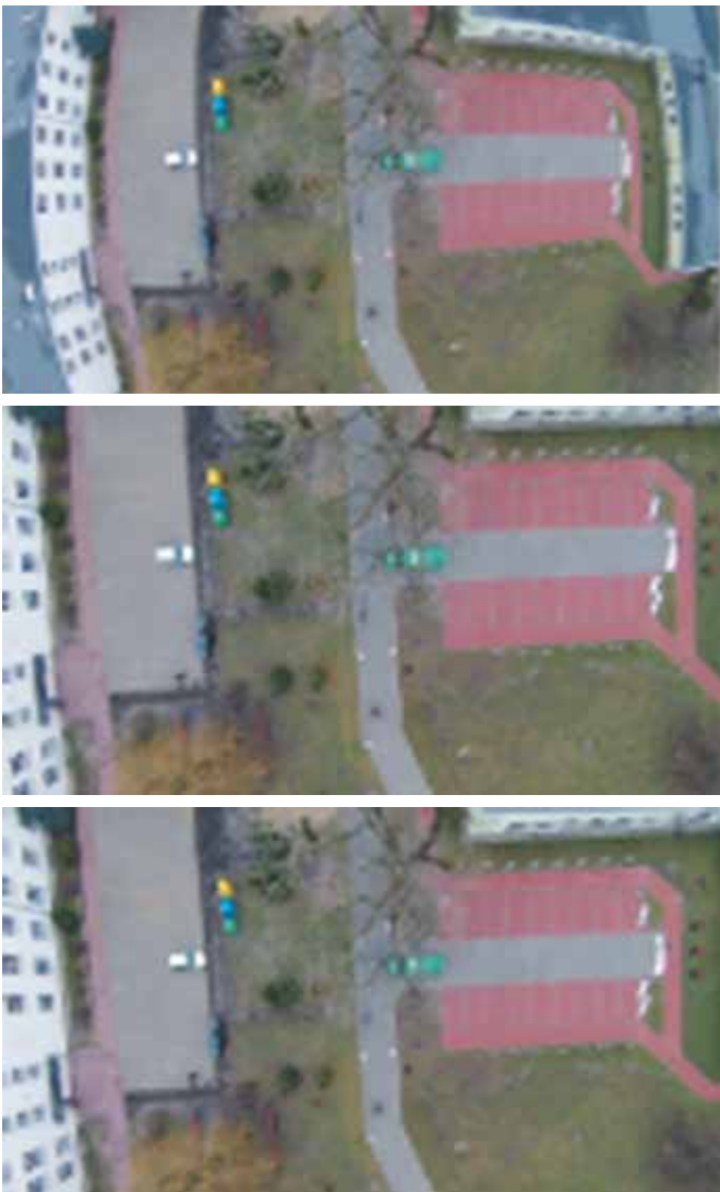
Fot. 2. Zdjęcia w kolejności od góry bez prostowania, prostowane za pomocą programu Gimp, prostowane za pomocą programu Photoshop. Źródło: materiał własny.
