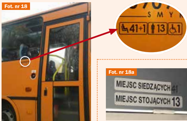
Znak wskazujący liczbę miejsc – umieszczony na zewnątrz (fot. nr 18) i wewnątrz (fot. nr 18a) pojazdu.
