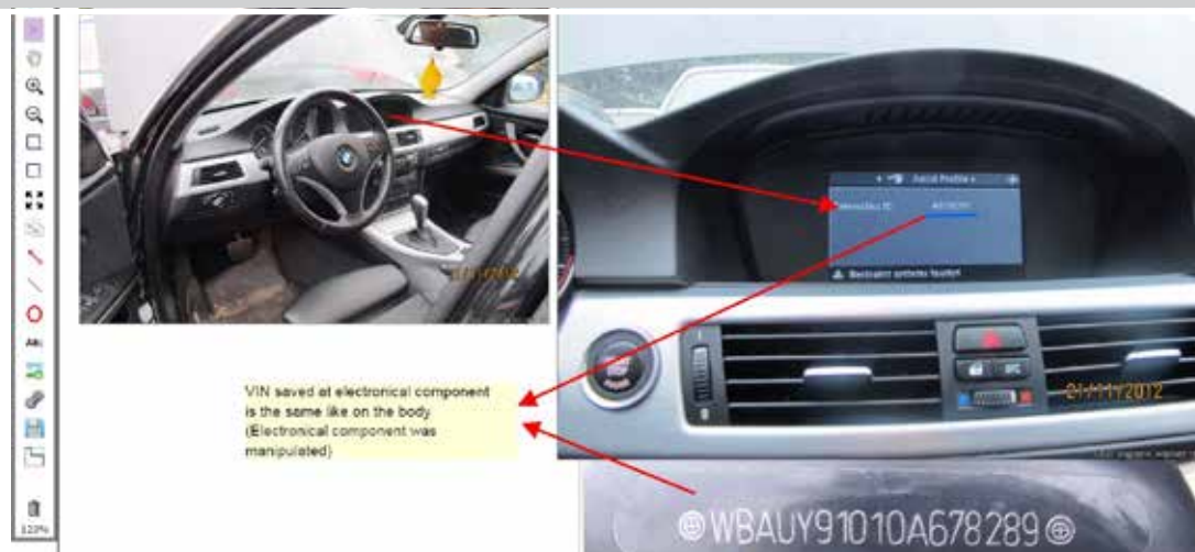
Fot. 9. Porównanie numeru identyfikacyjnego VIN występującego na nadwoziu pojazdu oraz zapisanego układzie elektronicznym pojazdu.
