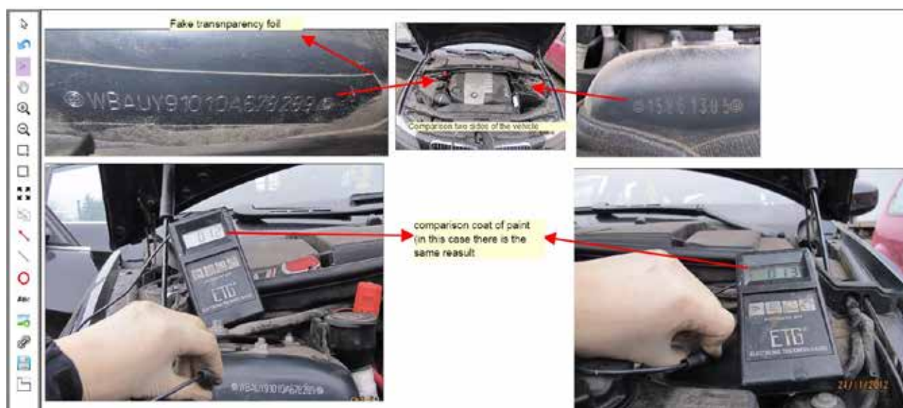
Fot. 10. Bezinwazyjne badanie powłoki lakierniczej w pojeździe przy użyciu miernika powłok lakierniczych.
