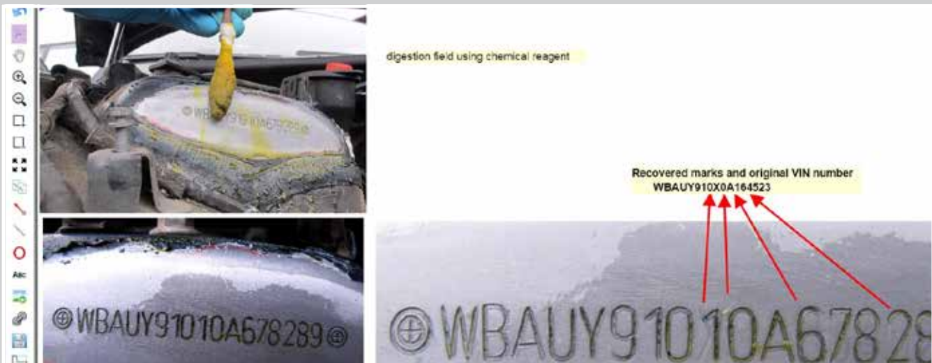
Fot. 11. Odtworzenie usuniętego oznaczenia identyfikacyjnego pojazdu VIN przy użyciu środków chemicznych.
