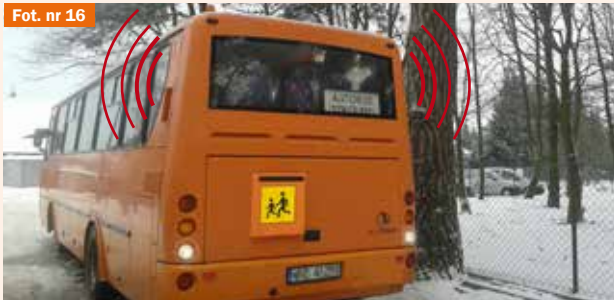
Fot. nr 16. Sygnalizacja akustyczna manewru cofania.
