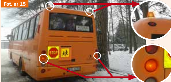
Fot. nr 15. Umieszczenie ostrzegawczego sygnału świetlnego błyskowego oraz światła awaryjne.
