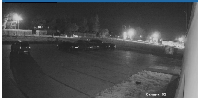
Fot. 3. Przykładowa klatka z monitoringu obiektu znajdującego się przy drodze. Widoczne słupki ogrodzenia posesji i lampy oświetlenia ulicznego są dobrymi elementami odniesienia do ustalania pozycji pojazdu.
