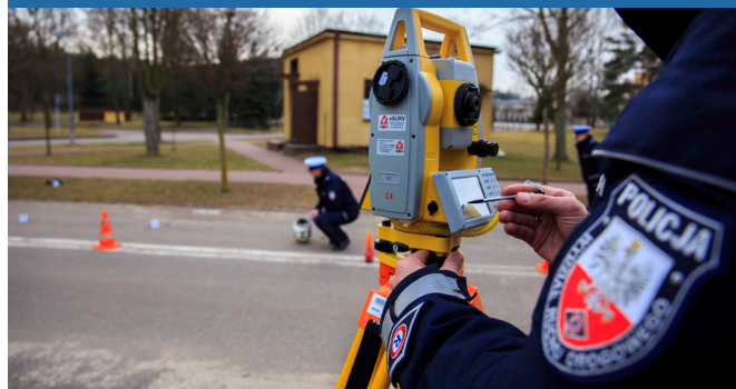
Fot. 1. System eSURV wykorzystywany w Policji do dokumentowania miejsc zdarzeń drogowych.
