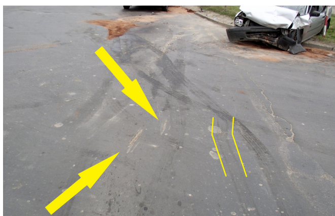
Fot. 16. Żółtymi liniami zaznaczono miejsce załamania śladu blokowania koła, strzałkami – zarysowania nawierzchni jezdni.
