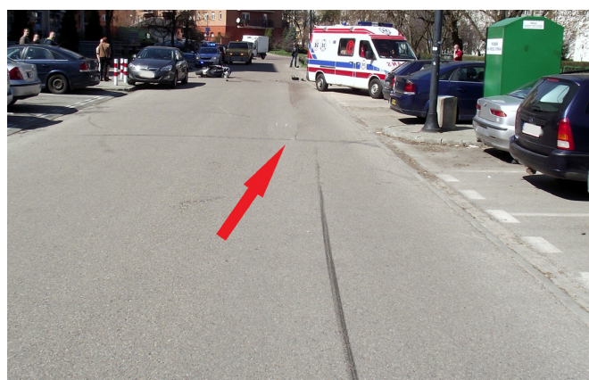
Fot. 19. Czerwoną strzałką zaznaczono zarysowania nawierzchni jezdni wskazujące miejsce upadku motocykla.
