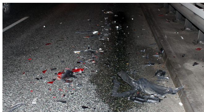
Fot. 2. Obszar odłamków szkła, tworzywa sztucznego i plama płynu eksploatacyjnego.
