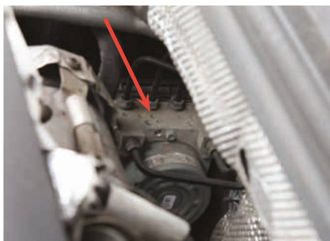
Ryc. 6. Modulator systemu ABS samochodu VW Passat (rok prod. 2017), umieszczony po prawej stronie komory silnika, przy ścianie grodziowej.
