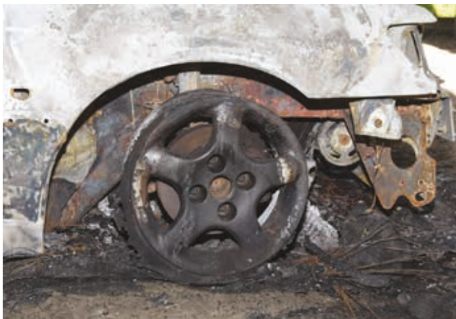
Fot. 9. Uszkodzenia termiczne koła.
