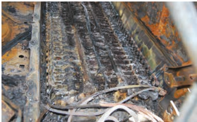
Fot. 7. Popożarowe uszkodzenia ogniwa w samochodzie o napędzie hybrydowym.
