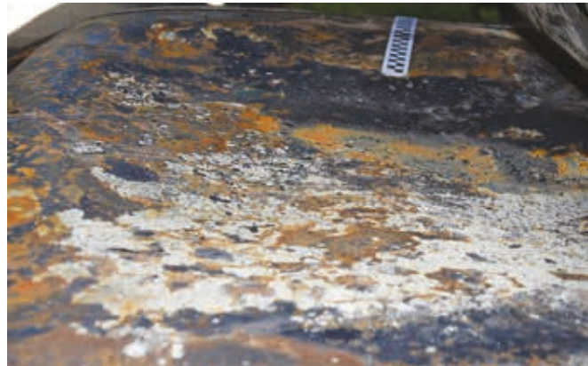
Fot. 8. Ślady termiczne spowodowane bezpośrednim działaniem wysokiej temperatury na dach pojazdu.
