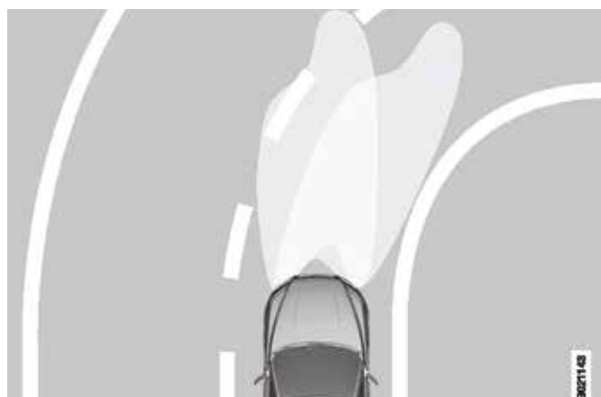
Ryc. 3. Snop światła reflektorów. Po lewej funkcja aktywnych reflektorów skrajnych wyłączona, po prawej włączona.
