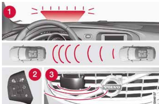
Ryc. 2. Elementy układu aktywnego tempomatu (ACC – Adaptive Cruise Control ). 1. Sygnalizacja ostrzegawcza. 2. Panel przycisków na kierownicy. 3. Czujnik radarowy.
