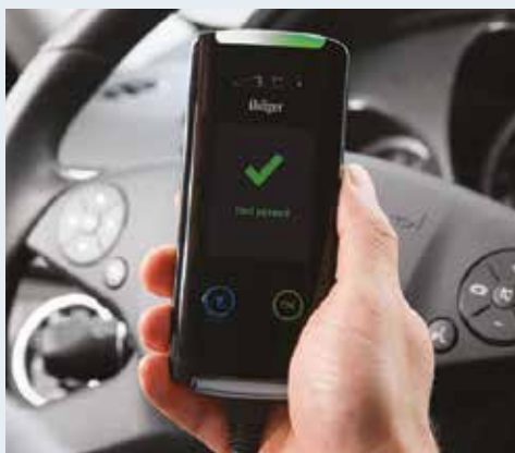
4. Zaakceptowany test oddechowy: rozrusznik zostaje odblokowany.
