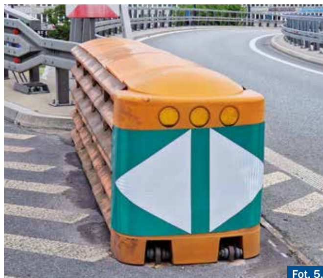
Fot. 5. Osłona energochłonna U-15a – przykład zastosowania.
