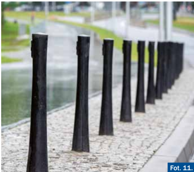
Ryc. 18. Słupek blokujący U-12c.
