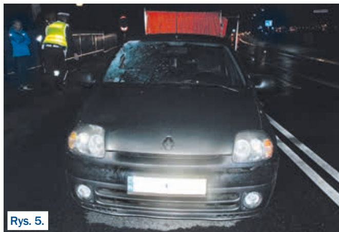
Rys. 5. Obraz uszkodzeń samochodu Renault. Zdj. z zasobów autora.
