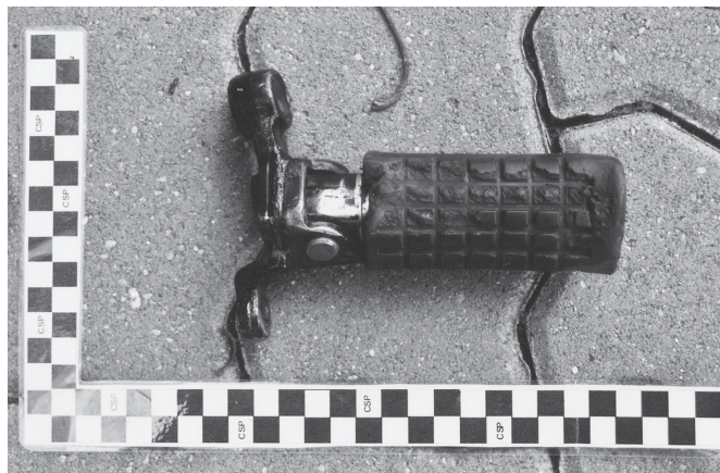
Oderwana boczna stopka motocykla
