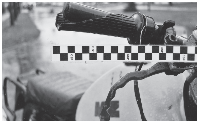
Uszkodzona manetka przepustnicy
