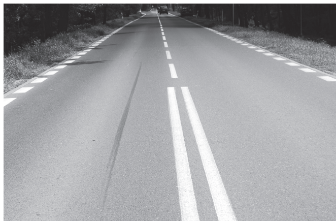
Ślad blokowania tylnego koła motocykla
