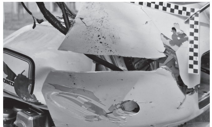
Rozerwana część owiewki motocyklowej
