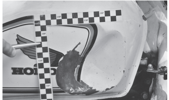
Wgniecenie i ubytki lakieru zbiornika paliwa
