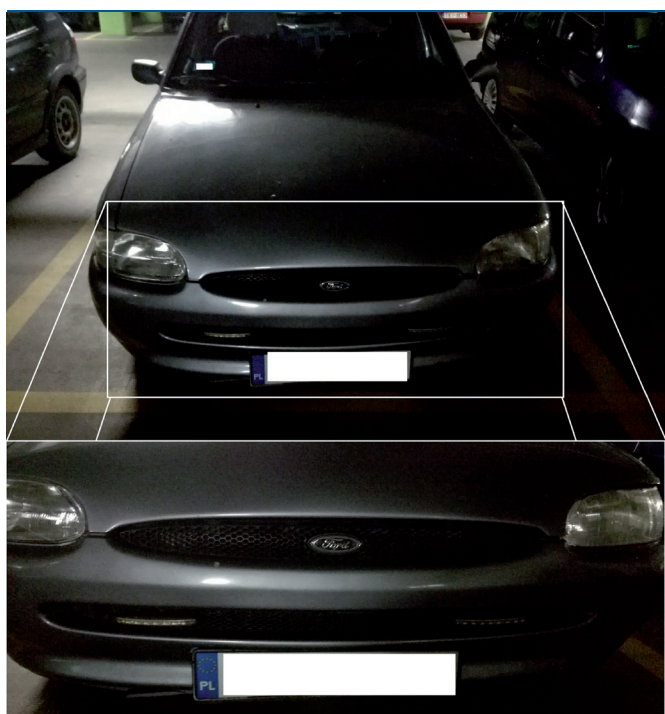
Fot. 6. Przykład nieprawidłowego rozmieszczenia światła do jazdy dziennej na pojeździe – niewłaściwa odległość między światłami [11]
