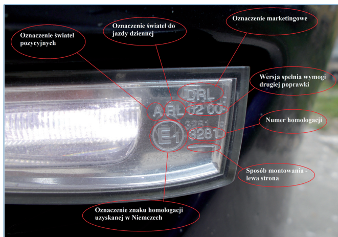
Fot. 2. Przykład światła do jazdy dziennej z oznaczeniem marketingowym DRL oraz homologacją europejską [11]
