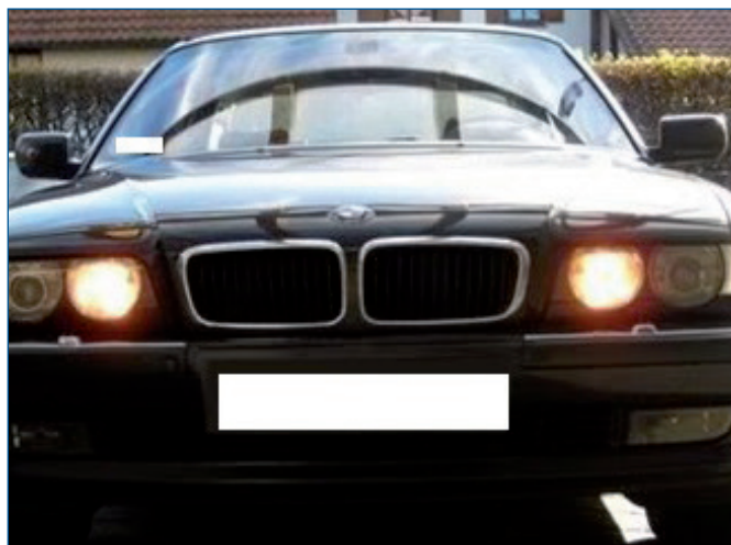
Fot. 3. Przykład samowolnej ingerencji w oświetlenie pojazdu, poprzez montaż regulatora mocy światła drogowych celem imitacji światła do jazdy dziennej, naruszającej przepisy dotyczące warunków technicznych pojazdów [10]
