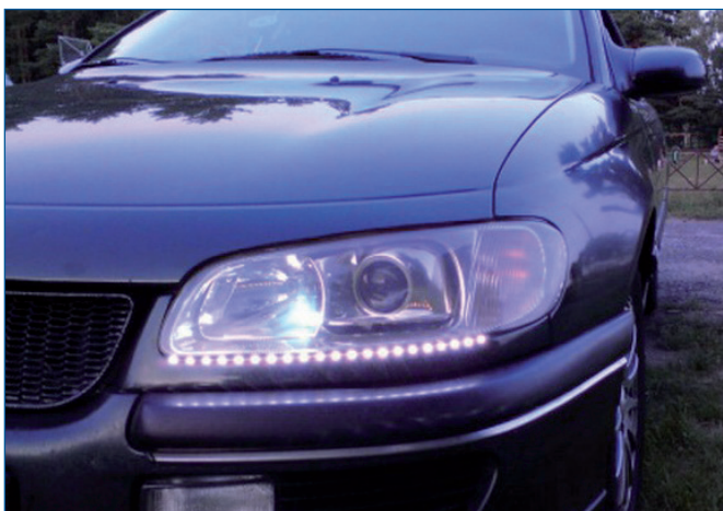
Fot. 4. Przykład samowolnej ingerencji w oświetlenie pojazdu, montażu taśmy LED przy reflektorze pojazdu imitującego światło do jazdy dziennej, naruszającej przepisy dotyczące warunków technicznych pojazdów [9]
