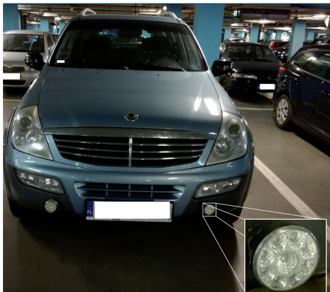
Fot. 5. Przykład światła do jazdy dziennej nieposiadającego międzynarodowego oznakowania homologacyjnego [11]
