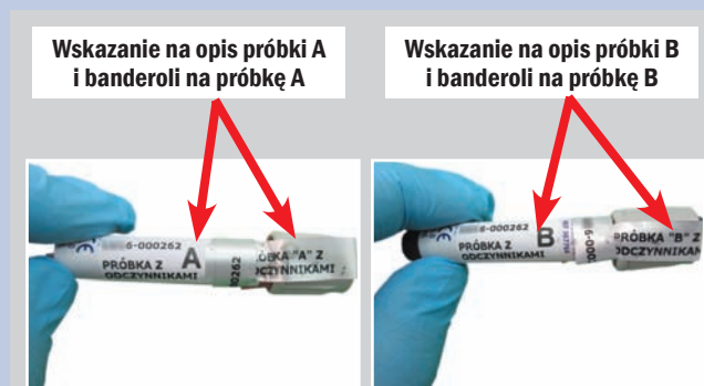
Fot. 5. Sposób oklejenia próbki banderolą
