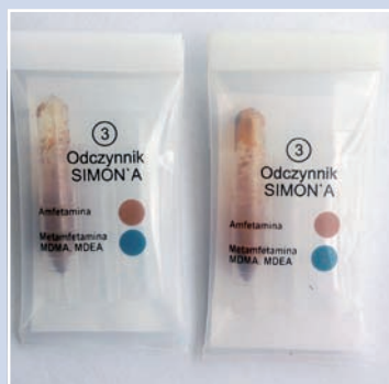
Narkotester z odczynnikiem Simona do wykrywania amfetaminy, metamfetaminy, MDMA [3,4-metylenodioksymetamfetaminy], MDEA [3,4-metylenodioksyetyloamfetaminy].
