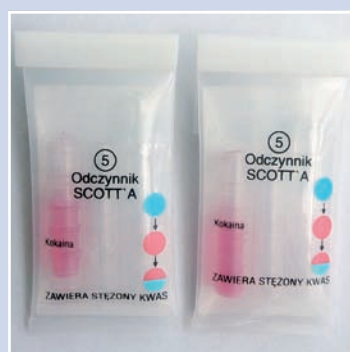
Narkotester zawierający stężony kwas z odczynnikiem Scotta do wykrywania kokainy.
