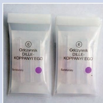
Narkotester z odczynnikiem Dille-Koppanyi'ego do wykrywania barbituranów.
