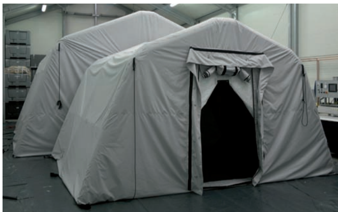
Fot. 1. Namiot do ujawniania śladów parami estru kwasu cyjanoakrylowego. Źródło: CLKP
