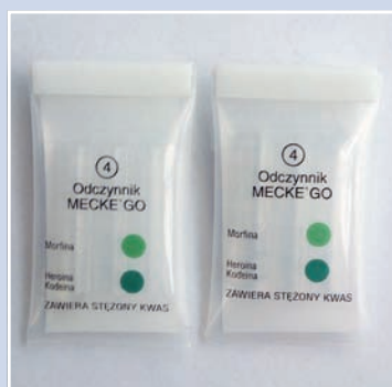
Narkotester zawierający stężony kwas z odczynnikiem Mecke'go do wykrywania morfiny, heroiny, kodeiny.
