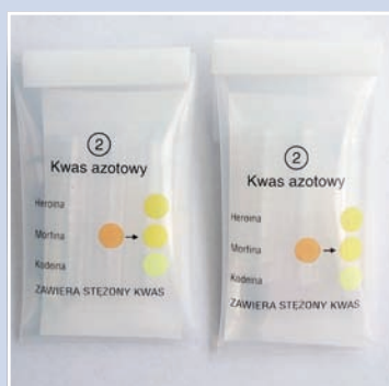
Narkotester zawierający stężony kwas azotowy do wykrywania heroiny, morfiny, kodeiny.
