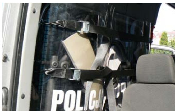
■ Sposób przewozu tarcz szturmowych w pojeździe „wypadowym”
