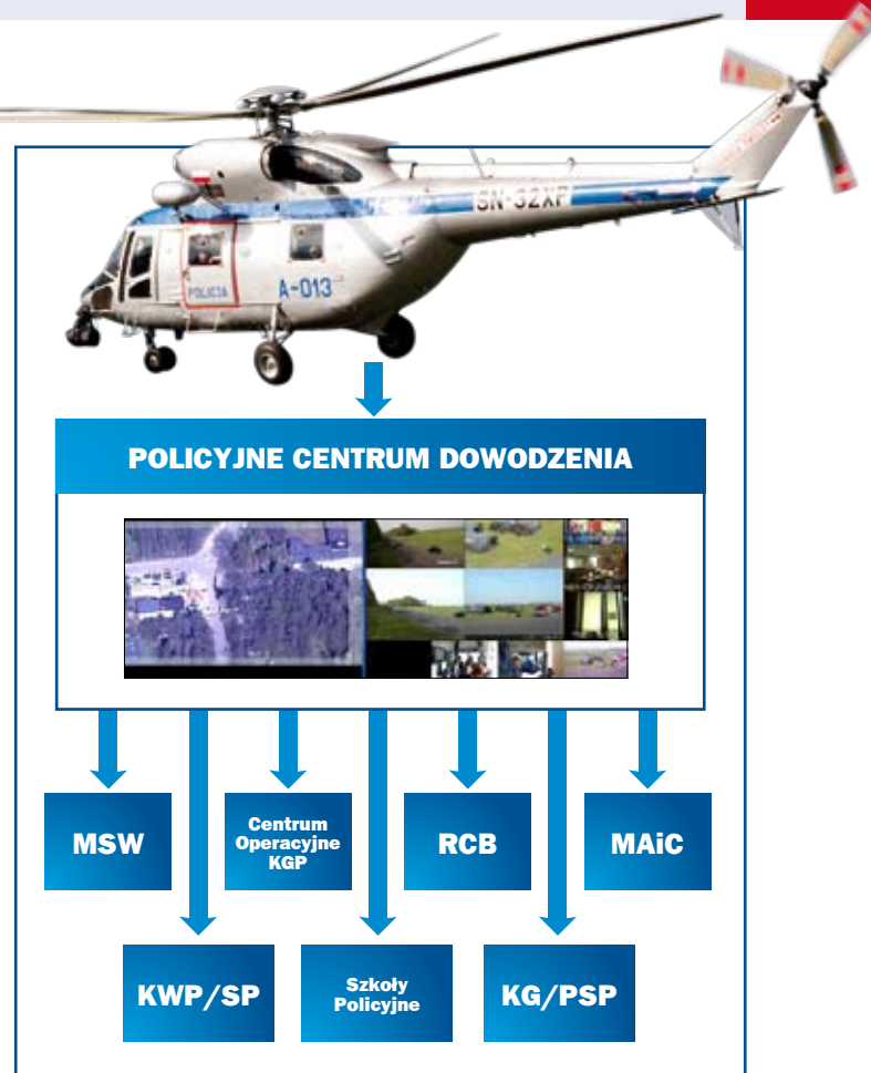
■ Przykład możliwości przekazywania obrazu z kamery zainstalowanej na śmigłowcu. Oprac. M. Szałajski, A. Żołądek
