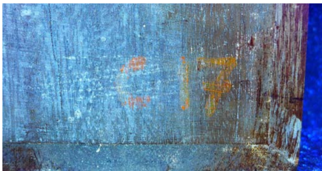
Fot. 7B. Ten sam fragment obiektu w świetle UV. Widoczne stare numery inwentarzowe które usunięto na tyle skutecznie, że w świetle dziennym przestały być czytelne.
