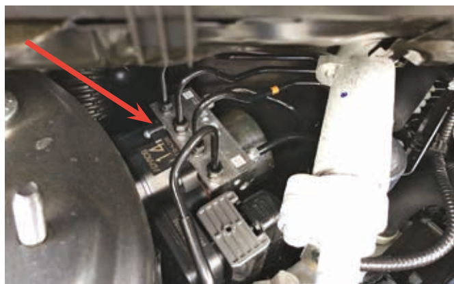
Ryc. 8. Modulator systemu ABS w komorze silnika samochodu Toyota RAV4 Hybrid.
