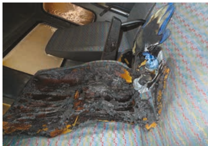
Fot. 10. Próba wzniecenia pożaru przez podłożenie butelki z cieczą łatwopalną.
