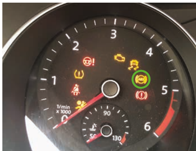
Ryc. 4. Kontrolki systemu ABS w zestawie wskaźników samochodu marki VW.
