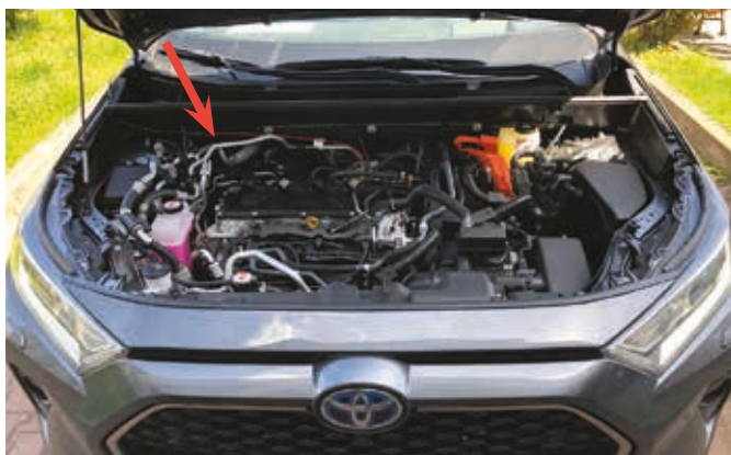
Ryc. 7. Usytuowanie modulatora systemu ABS w komorze silnika samochodu Toyota RAV4 Hybrid (rok prod. 2021).
