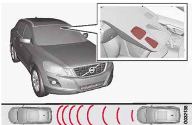
Ryc. 6. Okienka nadajnika i odbiornika czujnika laserowego (układ City Safety)
