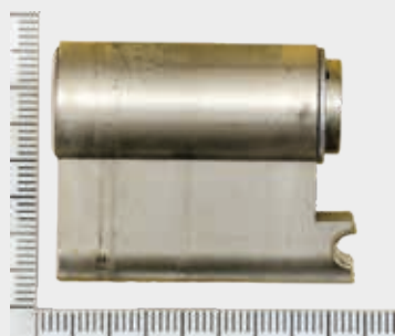
Fot. 3. Fotografia przedstawiająca cechy grupowe łamaka wkładek profilowych na powierzchni korpusu przełamanej części wkładki profilowej.
