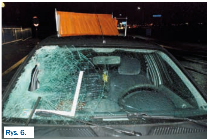
Rys. 6. Uszkodzenie szyby czołowej samochodu Renault. Zdjęcie z zasobów autora.
