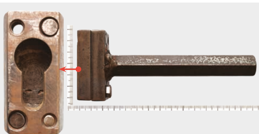
Fot. 9. Narzędzie (łamacz wkładek profilowych) zabezpieczony jako materiał porównawczy.
