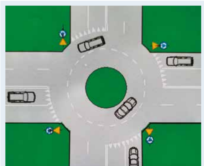
Rys. 1. Schemat skrzyżowania o ruchu okrężnym bez wyznaczonych pasów ruchu kierunków jazdy.
