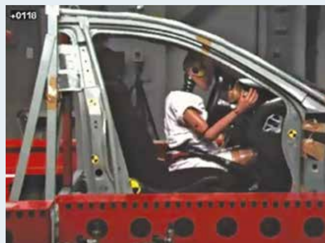
Ryc. 5. Moment kontaktu klatki piersiowej manekina z dolną częścią kierownicy w próbie symulującej kolizję z prędkością 13 km/h.
