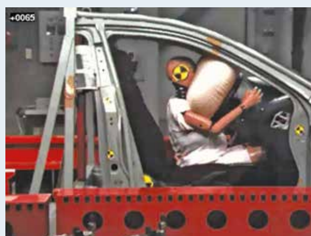
Ryc. 6. Moment kontaktu klatki piersiowej manekina z dolną częścią kierownicy w próbie symulującej kolizję z prędkością 26 km/h.
