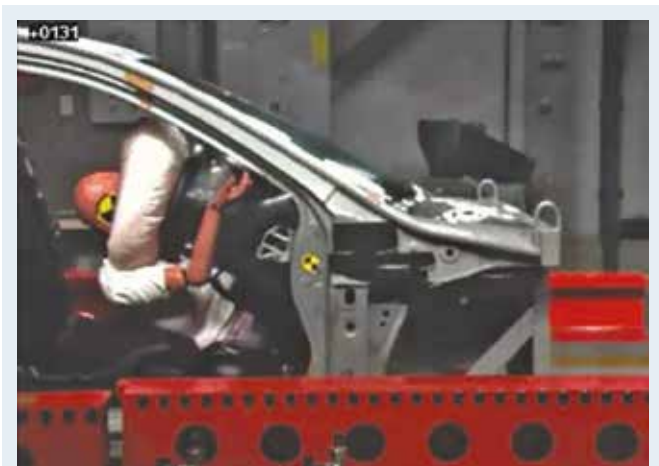
Ryc. 7. Wsuniecie torsu manekina pod deskę rozdzielczą w trakcie próby symulującej zderzenie z prędkością 40 km/h.
