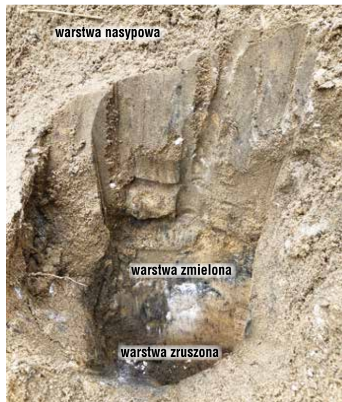
Fot. 11. Odkrywka (przekrój) lejów powstałego w wyniku detonacji ładunku materiału wybuchowego w glebie. Zdj. K. Poloczek.
