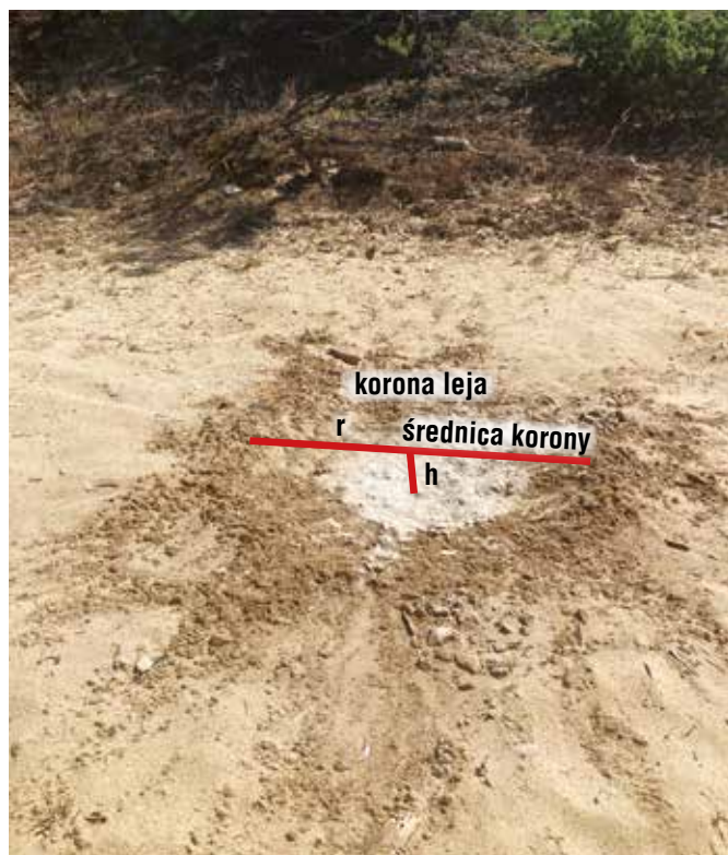
Fot. 10. Lej powybuchowy powstały w podłożu sypkim; r – promień lejów, h – głębokość widoczna lejów. Zdj. K. Poloczek.
