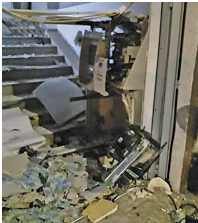
Fot. 9. Efekt zastosowania w bankomacie mieszaniny acetyleny z powietrzem – wybuch przestrzenny. Zdjęcie: K. Poloczek.
