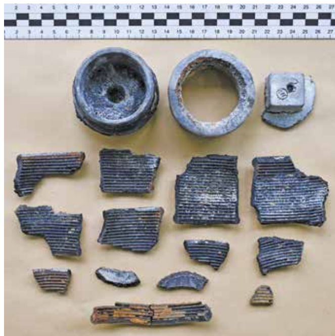
Fot. 4. Fragmentacja rury wskutek deflagracji. Zdj. K. Molski.
