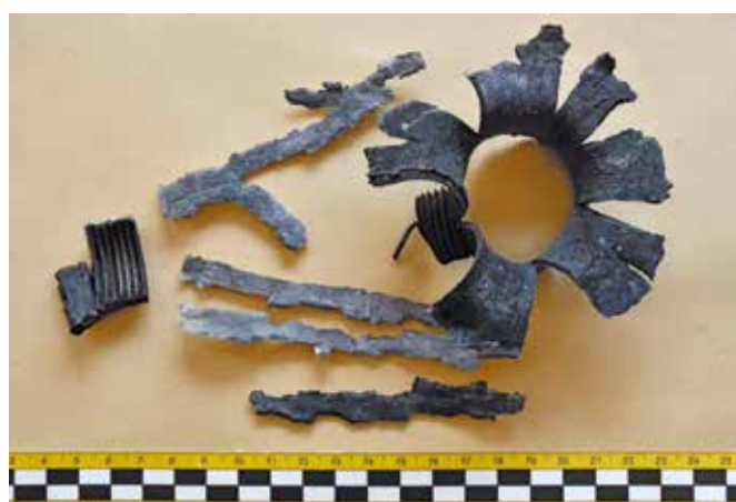
Fot. 7. Fragmentacja rury na skutek eksplozji. Zdj. K. Molski.
