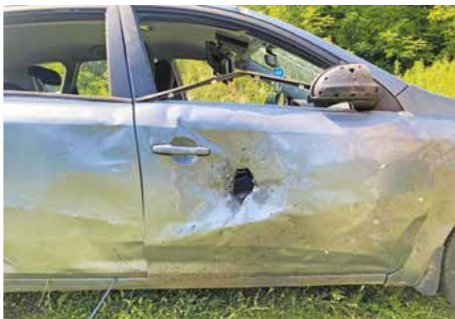
Fot. 12. Otwór w drzwiach samochodu jako skutek kierunkowego działania SUW umieszczonego na zewnątrz. Zdj. K. Poloczek.
