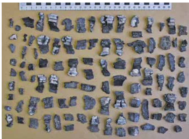
Fot. 5. Detonacja – fragmentacja rury. Zdj. K. Molski.
