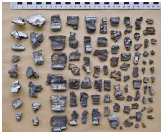
Fot. 7. Fragmentacja rury na skutek eksplozji. Zdj. K. Molski.
