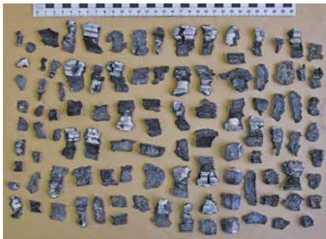
Fot. 5. Detonacja – fragmentacja rury. Zdj. K. Molski.
