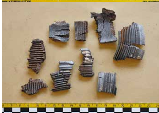
Fot. 8. Widoczne ślady okopceń – bilans ujemny, brak widocznych okopceń – bilans dodatni. Zdj. K. Molski.
