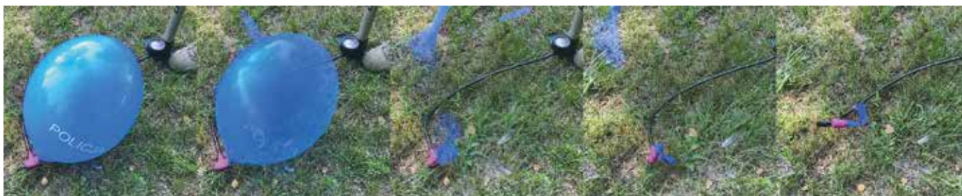
Fot. 3. Kolejne etapy rozrywania balonu jako przykład wybuchu fizycznego (rozsadzenia). Zdj. K. Molski.
