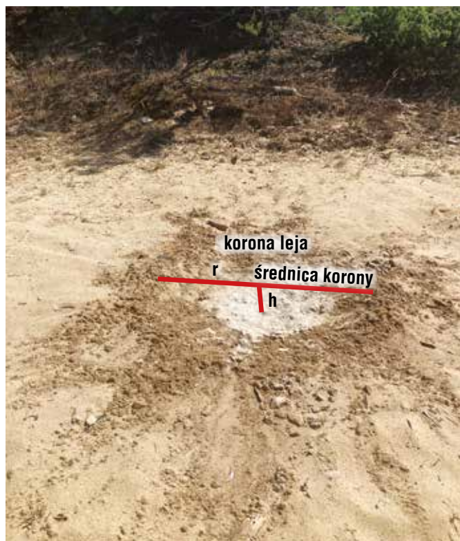
Fot. 10. Lej powybuchowy powstały w podłożu sypkim; r – promień leja, h – głębokość widoczna leja. Zdj. K. Poloczek.
