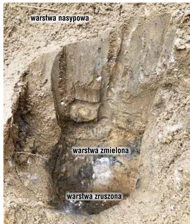
Fot. 11. Odkrywka (przekrój) leja powstałego w wyniku detonacji ładunku materiału wybuchowego w glebie. Zdj. K. Poloczek.
