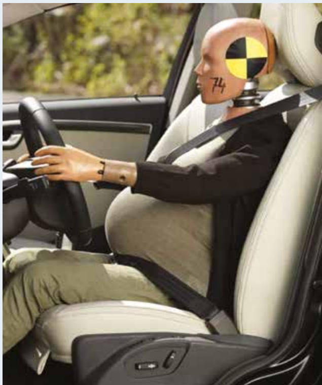
Ryc. 3. Ustawienie oparcia fotela i przebieg taśmy pasa bezpieczeństwa na przykładzie manekina ciężarnej.
