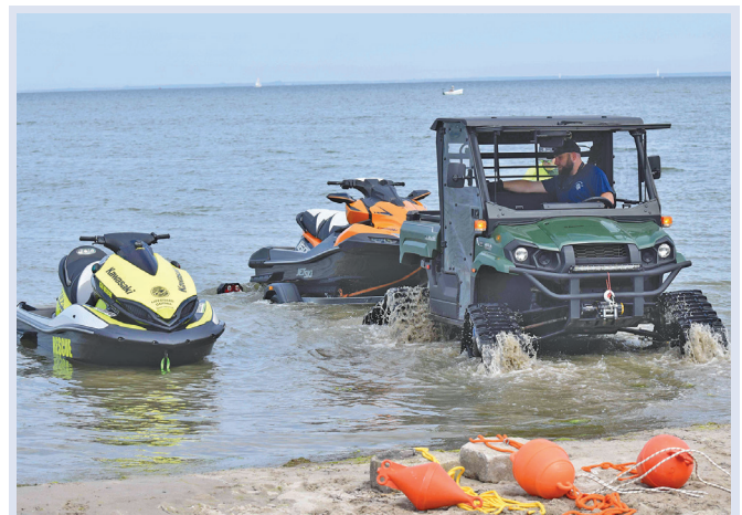
Fot. 19. Pojazd Mule na gąsienicach służący m.in. do wodowania jednostek pływających bezpośrednio z plaży.
