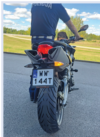
Fot. 5. Kontrola stanu technicznego oświetlenia motocykla z tyłu – sprawdzenie działania światła pozycyjnego i kierunkowskazów.
