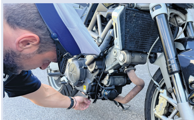
Fot. 15–16. Kontrola wycieków płynów eksploatacyjnych.
