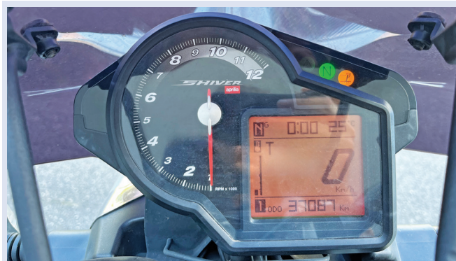
Fot. 1. Kontrola stanu technicznego prędkościomierza, drogomierza i samodiagnostyki układów motocykla.
