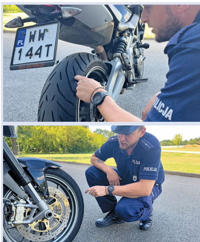
Fot. 12–13. Kontrola stanu technicznego ogumienia.
