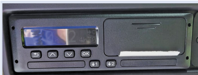
Fot. 1. Tachograf inteligentny drugiej generacji SE5000 Smart 2.
