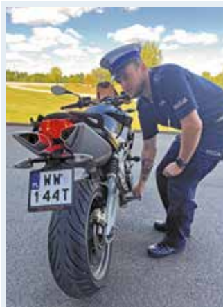
Fot. 7. Kontrola stanu technicznego oświetlenia motocykla z tyłu – sprawdzenie działania światła hamowania poprzez naciśnięcie dźwigni hamulca nożnego.
