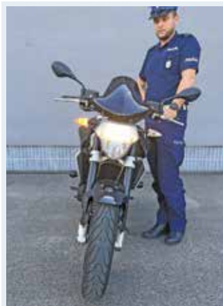
Fot. 4. Kontrola stanu technicznego oświetlenia motocykla z przodu – sprawdzenie działania światła mijania i kierunkowskazów.
