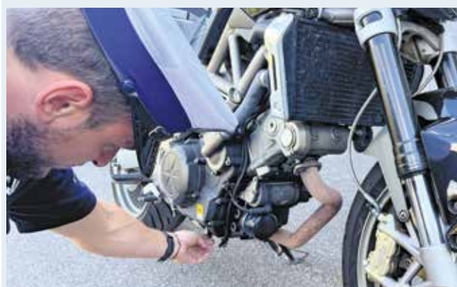
Fot. 15–16. Kontrola wycieków płynów eksploatacyjnych.
