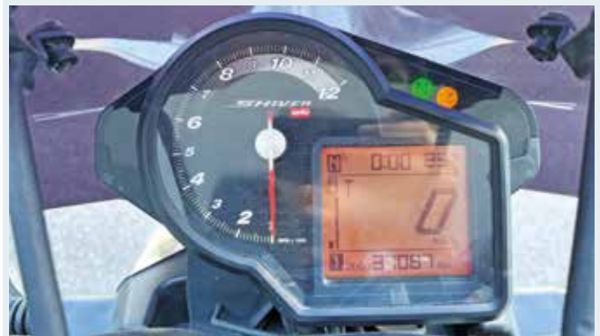
Fot. 1. Kontrola stanu technicznego prędkościomierza, drogomierza i samodiagnostyki układów motocykla.
