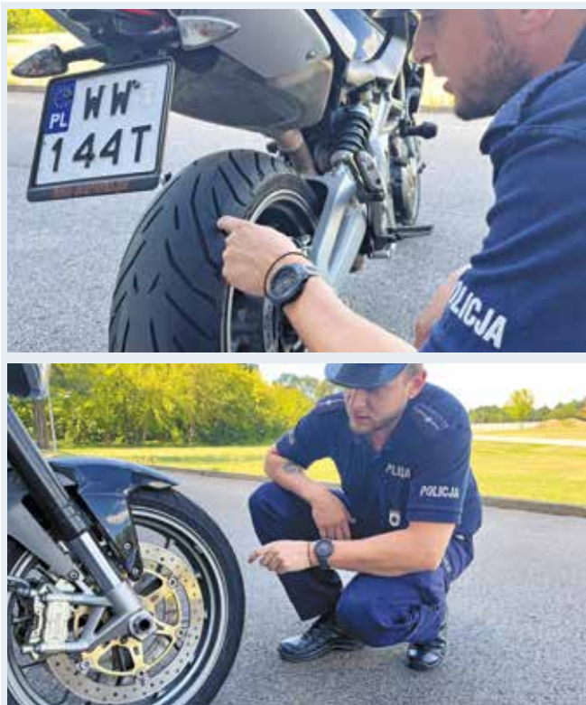
Fot. 12–13. Kontrola stanu technicznego ogumienia.
