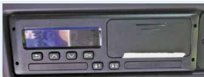
Fot. 1. Tachograf inteligentny drugiej generacji SE5000 Smart 2.
