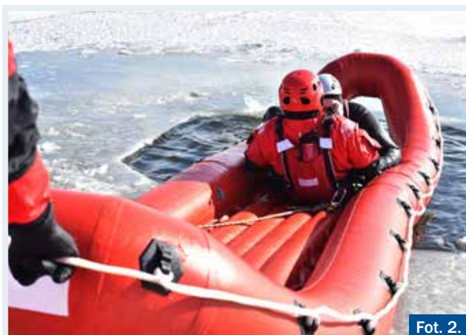
Fot. 2–3. Pneumatyczne sanie ratownicze wodno-łodowe RS1.
