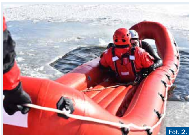
Fot. 2–3. Pneumatyczne sanie ratownicze wodno-łodowe RS1.
