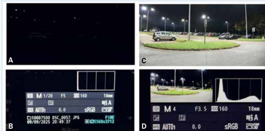
Fot. 1. Zdjęcia parkingu w warunkach nocnych: A – wykonane zgodnie ze wskazaniami światłomierza; C – wykonane na przedłużonym czasie naświetlania; B i D – wskazania paramentów dla poszczególnych zdjęć i histogram.
