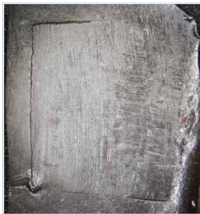
Fot. 5. Replika silikonowa śladu porównawczego wykonanego na powierzchni blachy ołowianej przy użyciu wkrętaka zabezpieczonego jako materiał porównawczy.
