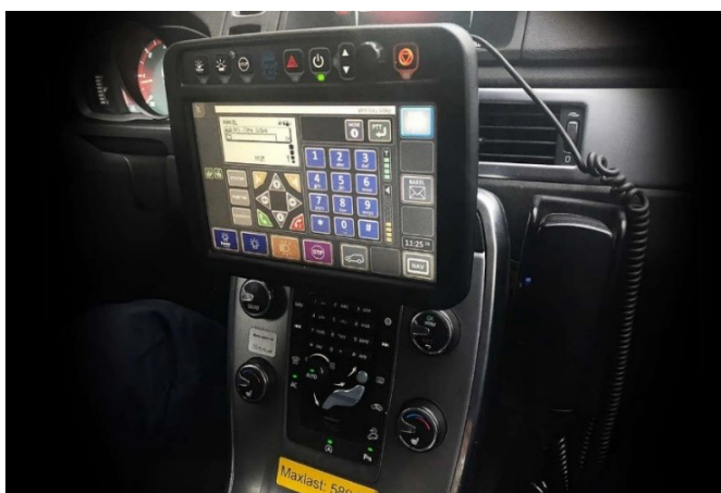
Fot. 9. Przykład instalacji radiotelefonu w szwedzkiej Policji. Źródło: Sepura, https://polistidningen.se/2019/12/studie-det-behovs-mer-forskning-om-raket/ [dostęp: 1.10.2025 r.].
